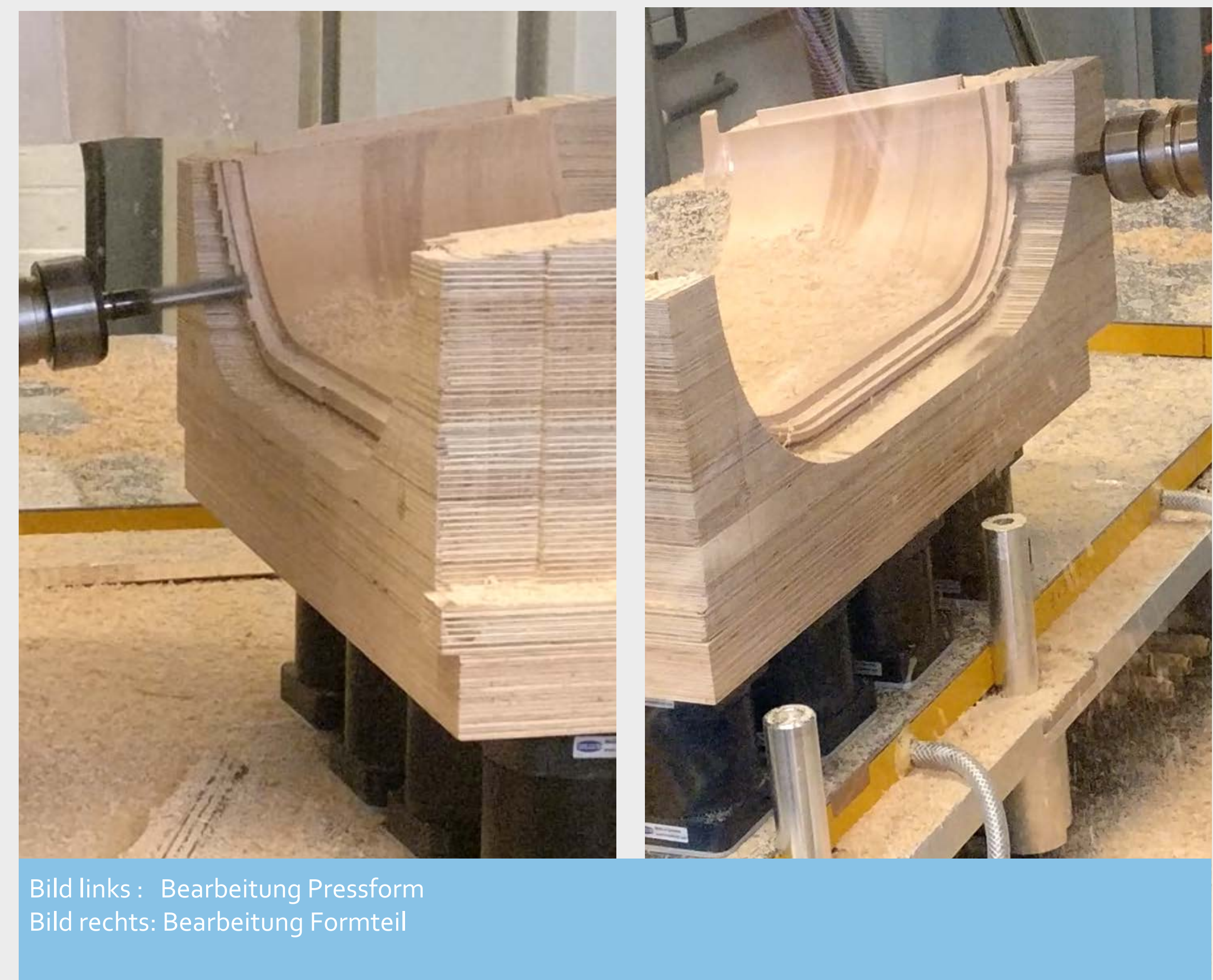
Bild links : Programmierung der Bearbeitungsform Bild rechts : Programmierung des Formteils
