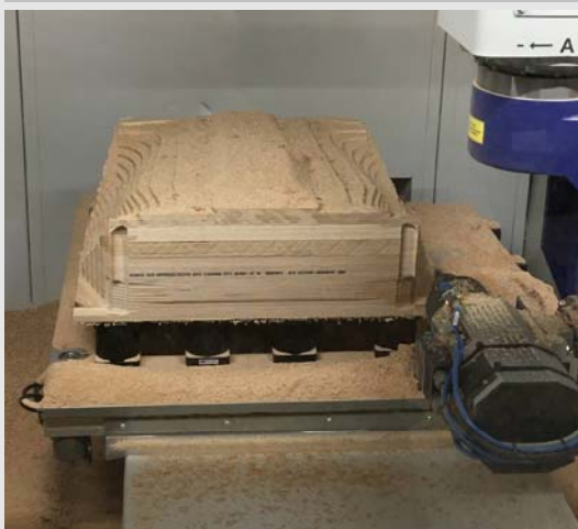
Bild links: Schruppfräsen der Spannvorrichtung Bild rechts: Formatierung der Sitzfläche
