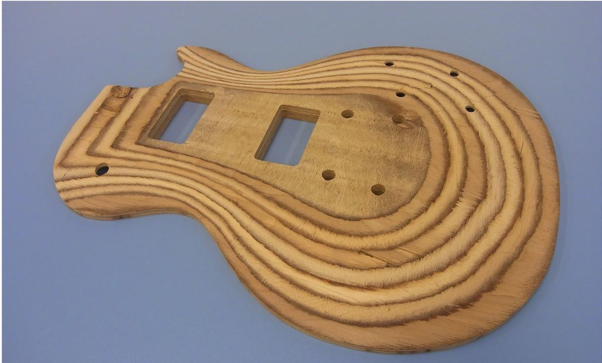
*Probefräsung der Decke aus Multiplex*
