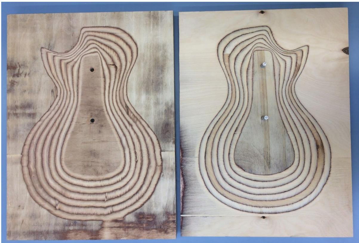
*Pressform zum Erstellen der Schichtholzdecke*
