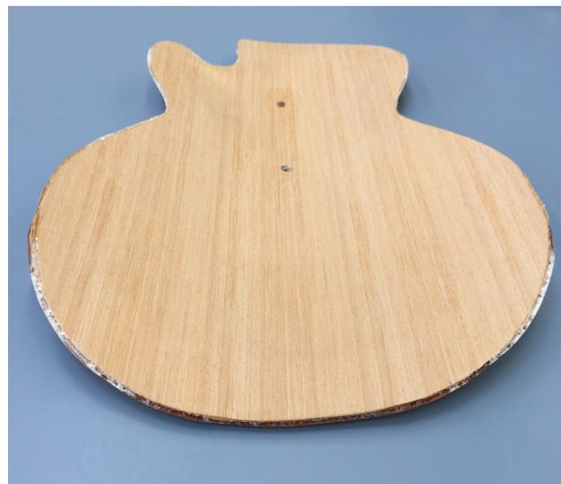
*“Schaufel”, stark verformte Decke*
