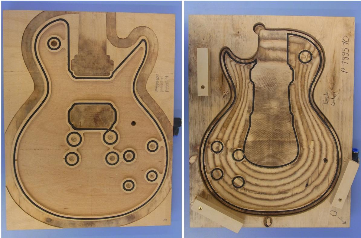
*Vorrichtung zum Fräsen der Deckenoberseite (links), Die Vorrichtung zum Fräsen der Deckenunterseite (rechts)*
