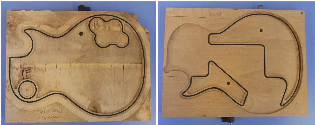
Vorrichtung zum Fräsen der Korpusoberseite (rechts) und der Korpusunterseite (links)
