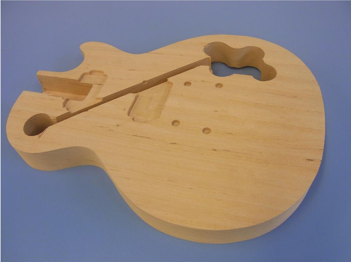
*Probefräsung des Korpus aus Linde*
