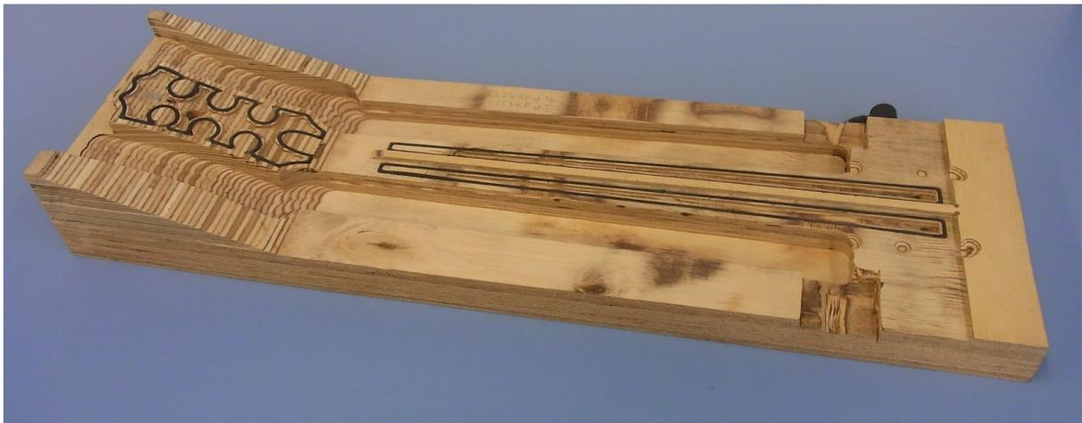
*Vorrichtung zum Fräsen der Halsunterseite*
