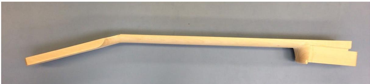
*Probefräsung des Halses aus Linde in Draufsicht und Seitenansicht*
