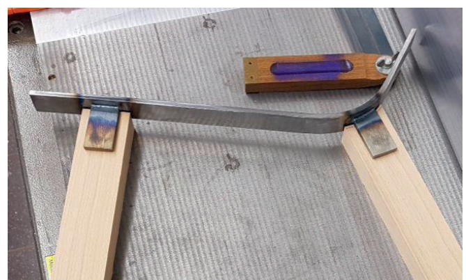
Abbildung 22: Stahllamelle mit Flansch
