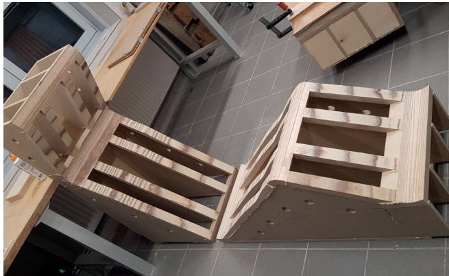
Abbildung 11: Konditionierform (Ober- und Unterform)
