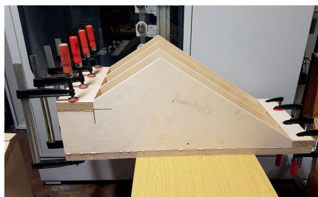
Abbildung 10: Pressform beim Zusammenbau ohne Oberfläche. Blick auf die Stützen.
