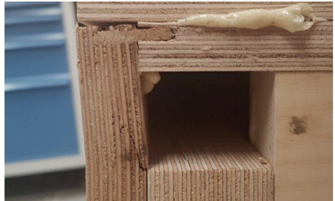
Abbildung 18: Bruch der Pressform an der plangefrästen Stütze (<20 Millimeter)
