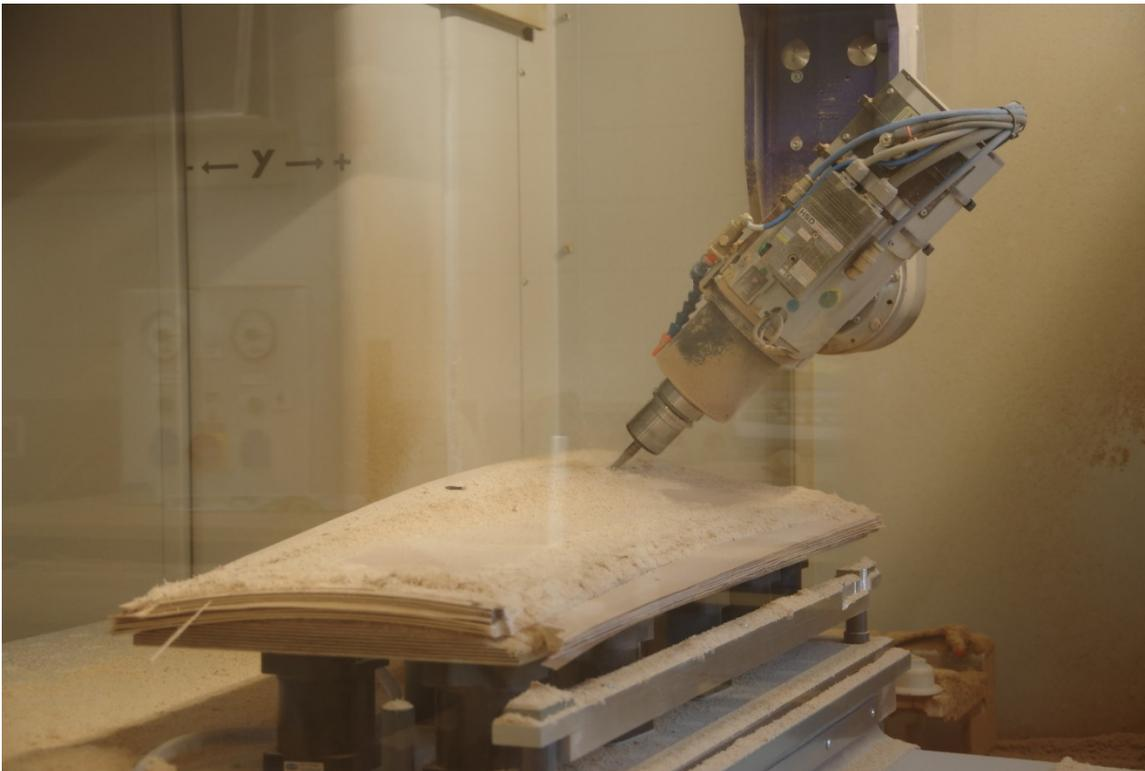
Im letzten Arbeitsgang werden zwei Nuten für Boden und Mittelboden sowie die Formatierung der Kanten gefräst. Für die Kantenbearbeitung der Seiten wurde der Befehl „Fräsbahn aus zwei Konturen“ gewählt, da wir so flexibel einen geringen Hinterschnitt der Gehrungen erzeugen können, sodass mit Sicherheit alle Gehrungen des Korpus an der Außenseite geschlossen sind.
