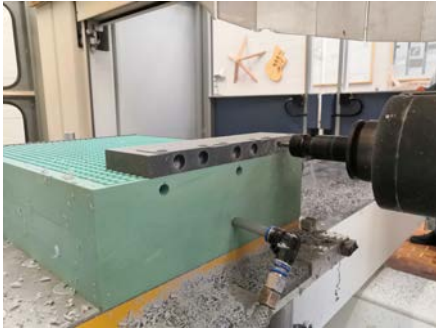
Abbildung 15 2. CNC-Bearbeitung Beschlag Abgeschlossen wurde die Bearbeitung mit der Konturbearbeitung.
