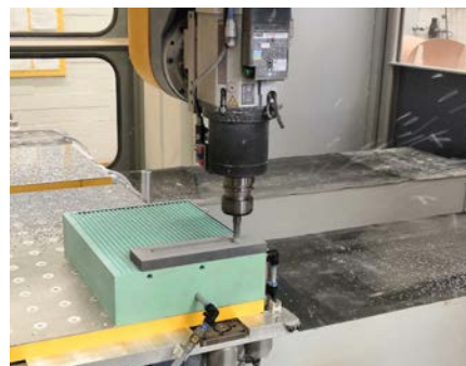
Abbildung 14 1. CNC-Bearbeitung Beschlag Sobald das Rohteil fixiert war, begann die Bearbeitung. Aus einem der Rohteile haben wir die maximale
