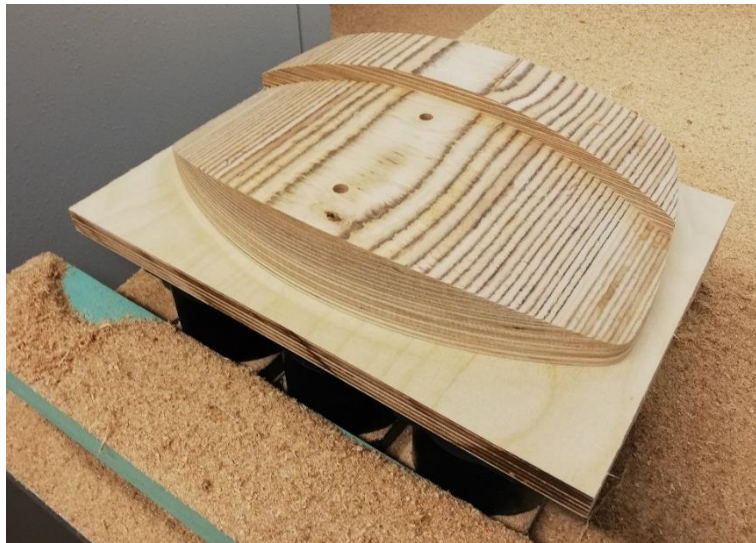
Abbildung 8: Die Unterseite der Kopfstütze wird gefräst
