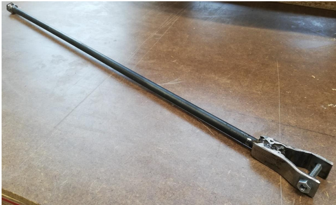
Abbildung 12: Die Stahlstange überträgt die Längenverstellung ans Ende des Rollbretts
