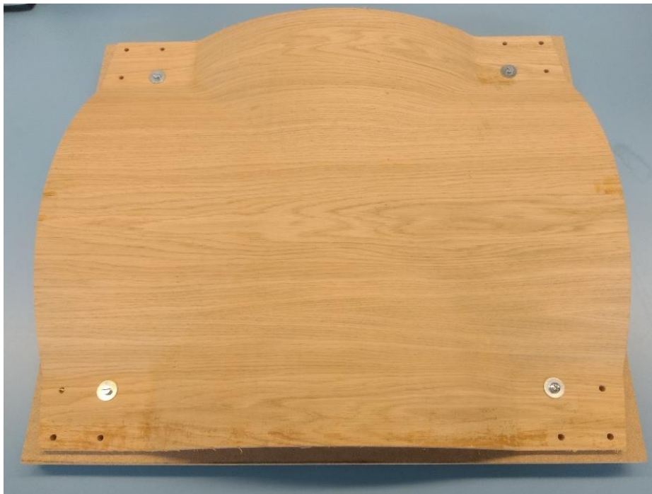
Abbildung 7: Das Kopfteil wurde auf einer FPY 19 festgeschraubt
