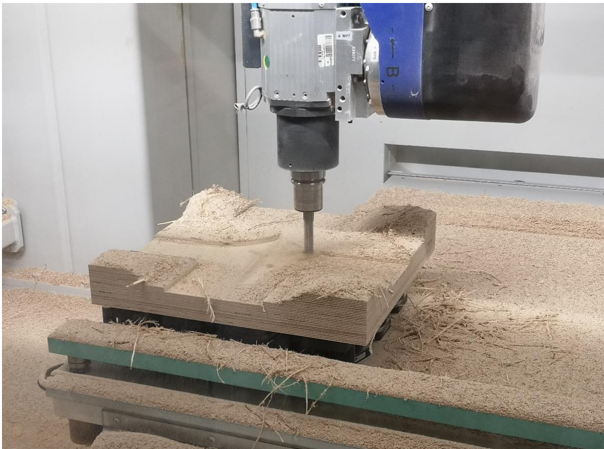
Abbildung 3: Schruppfäsen der Pressform an der MAK A 3 mit dem T120 Schruppfräser
