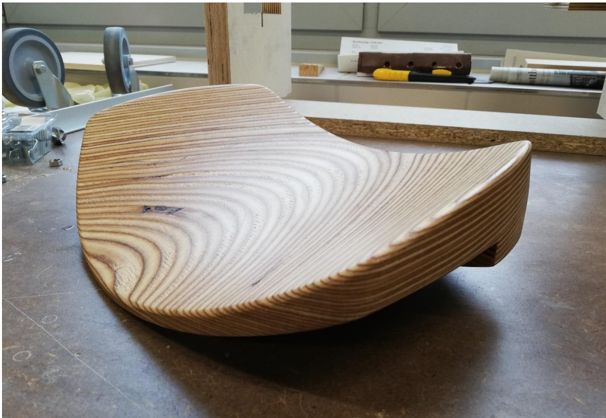
Abbildung 10: Die fertige Kopfstütze ist oben geschwungen und unten an die Kante des Rollbretts angepasst
