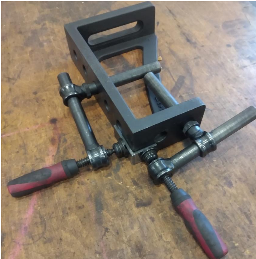
Abbildung 11: Durch das Fixieren in der Vorrichtung lässt sich ein 90 Grad Winkel schweißen
