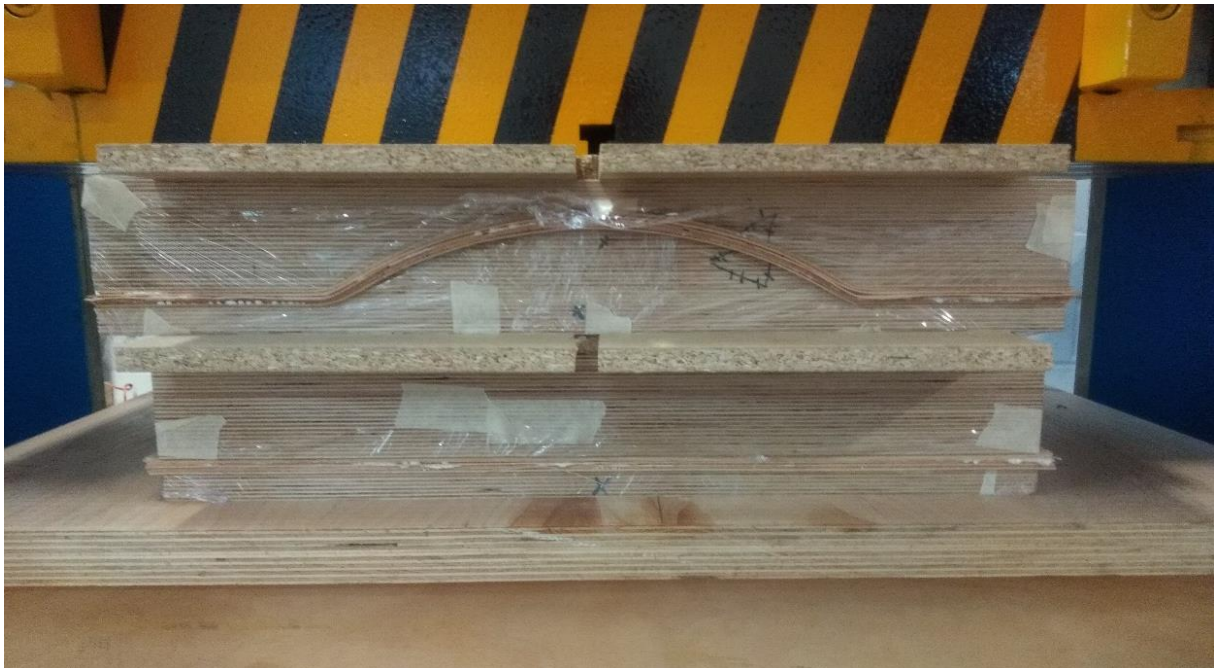
Abbildung 4: Pressen der beiden Formteile übereinander in der Hydraulikpresse
