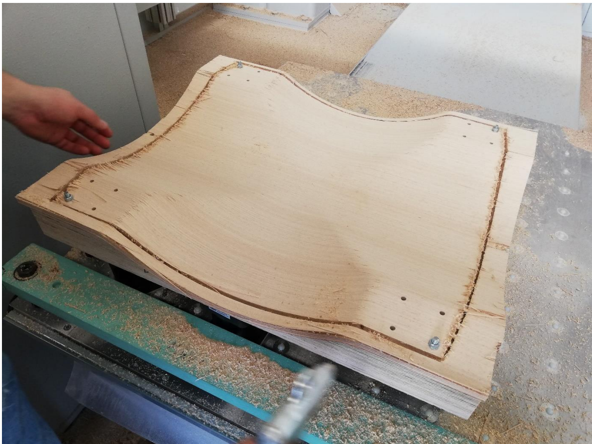
Abbildung 13: Links sind deutlich die Ausrisse zu erkennen
