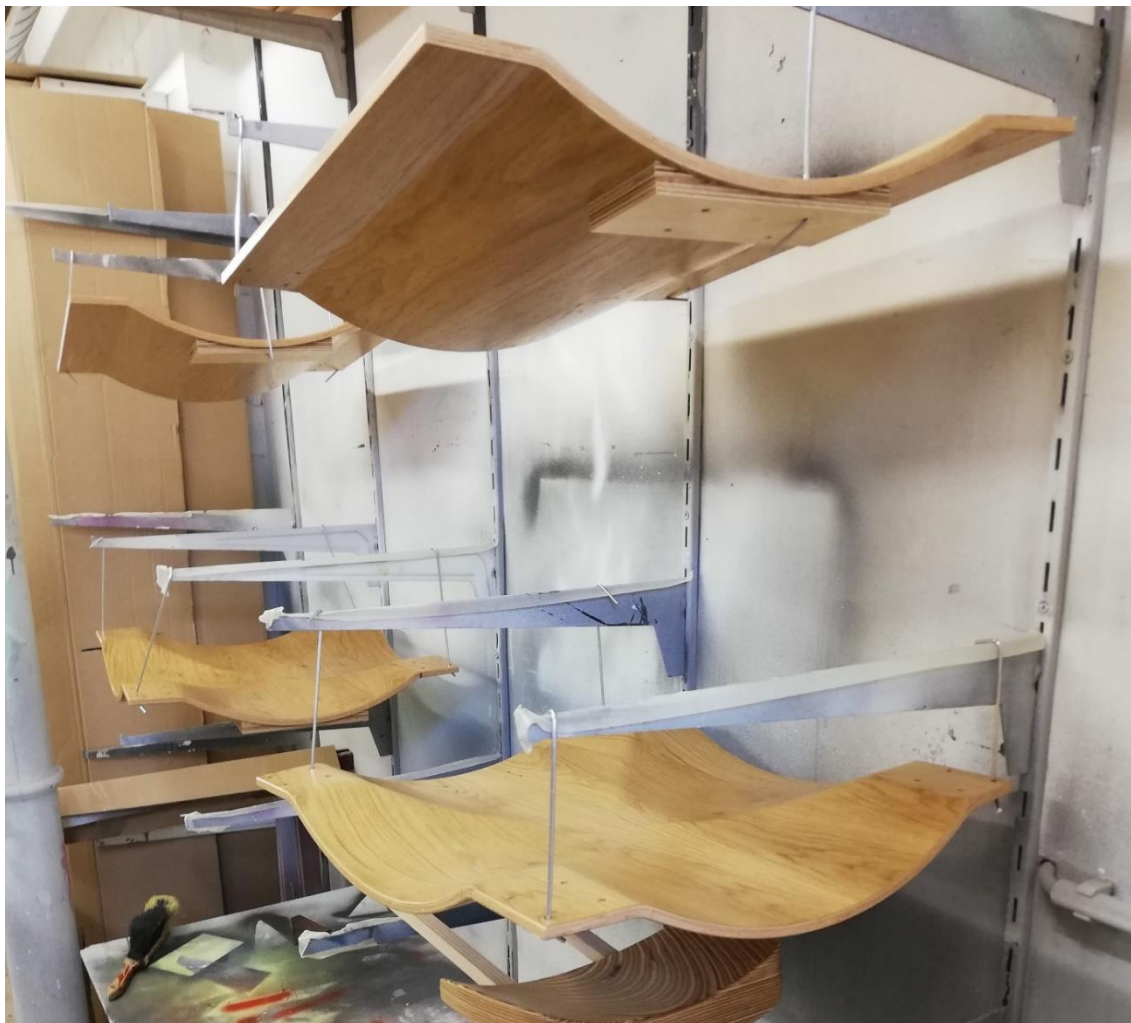
Abbildung 15: Nach dem Lackieren werden die Teile zum Trocknen aufgehängt
