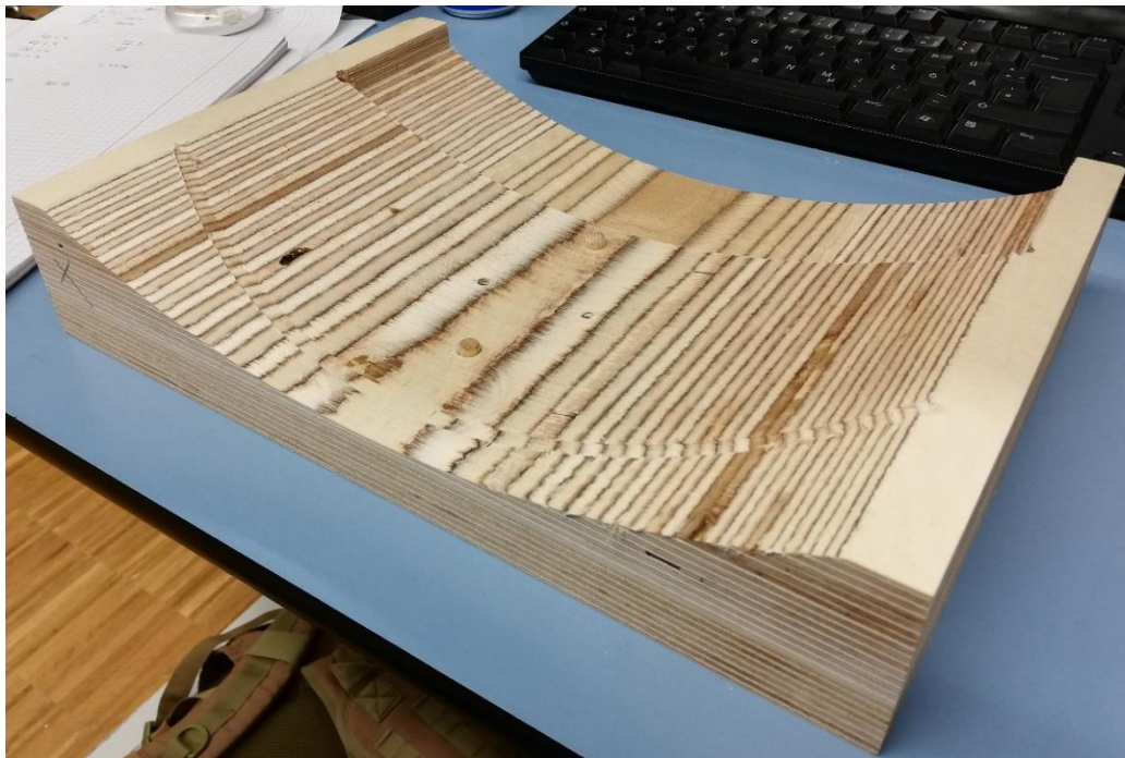
Abbildung 9: Die fertige Schablone mit zwei Dübeln zum Positionieren
