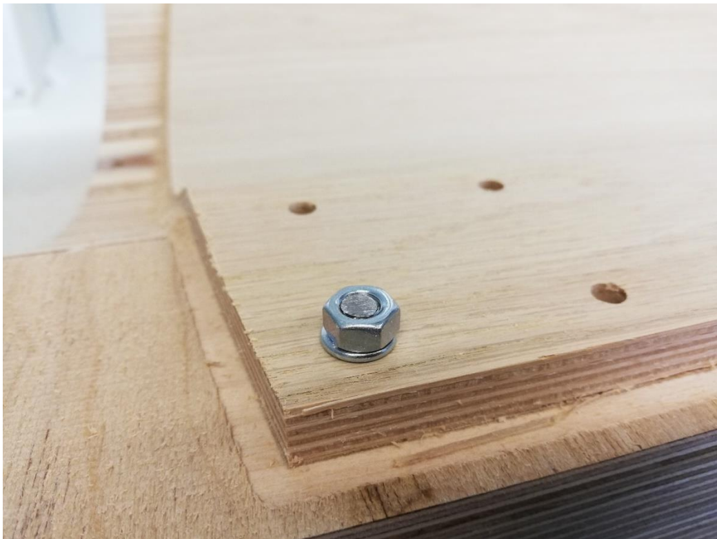
Abbildung 14: Durch Anritzen der oberen Furnierschichten entsteht ein sauberes Kantenbild
