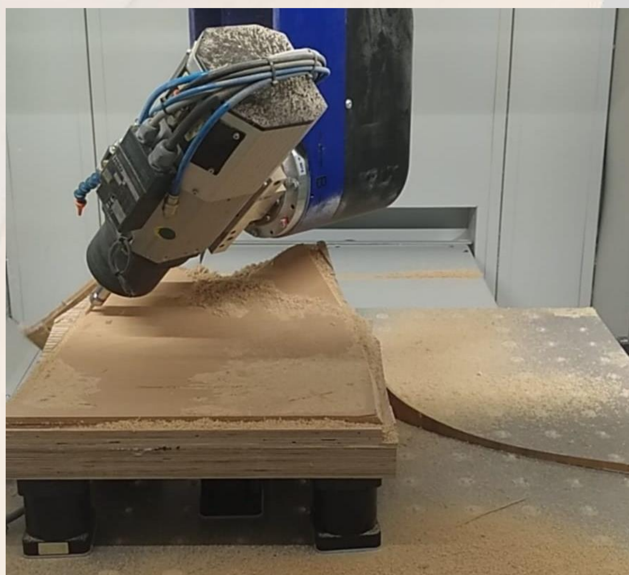
Bild links : 5 – Achssimultan Formatierung des Deckels Bild rechts: Fertiges PC-Gehäuse
