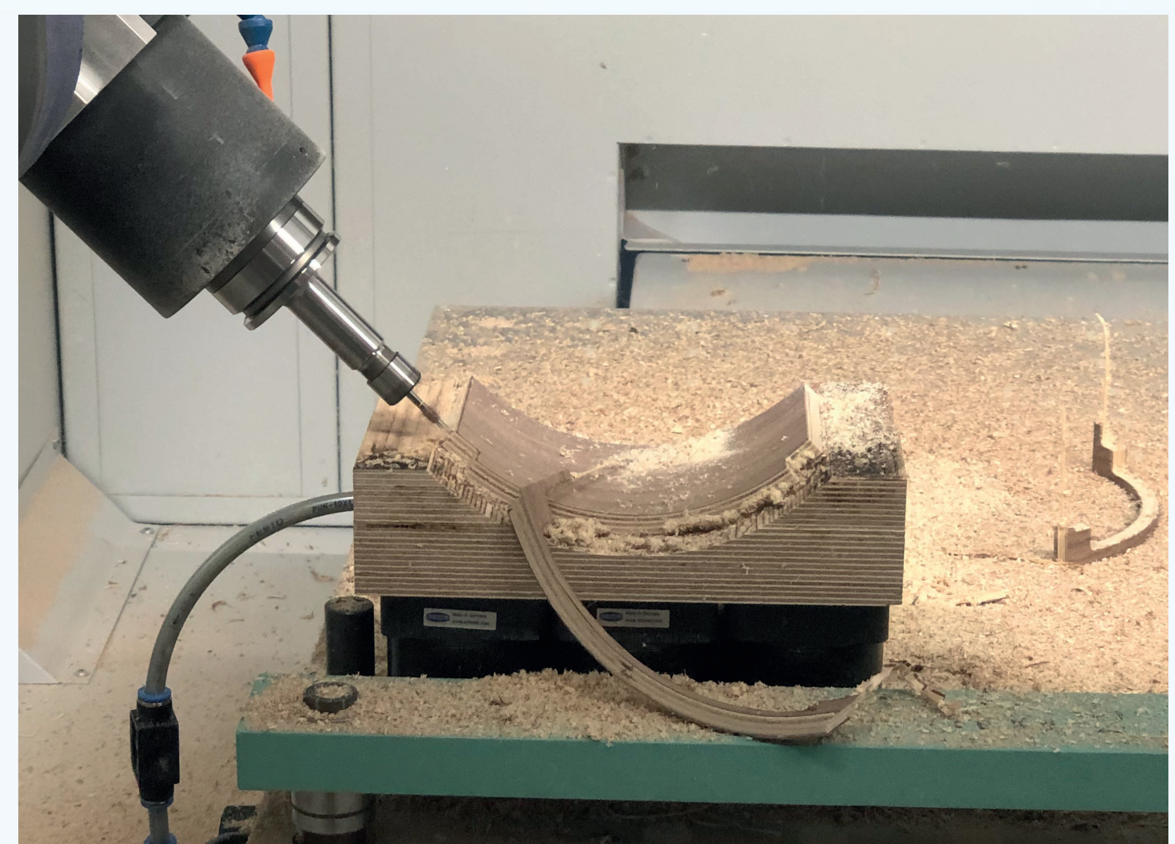
Bild links: Fräsen der Pressform des Rotorblattes Bild rechts: Fräsen des Bogenviertels
