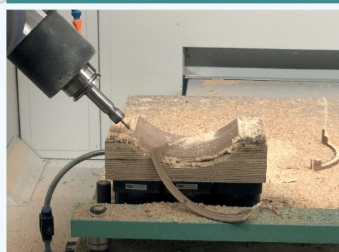
Bild links: Fräsen der Pressform des Rotorblattes Bild rechts: Fräsen des Bogenviertels
