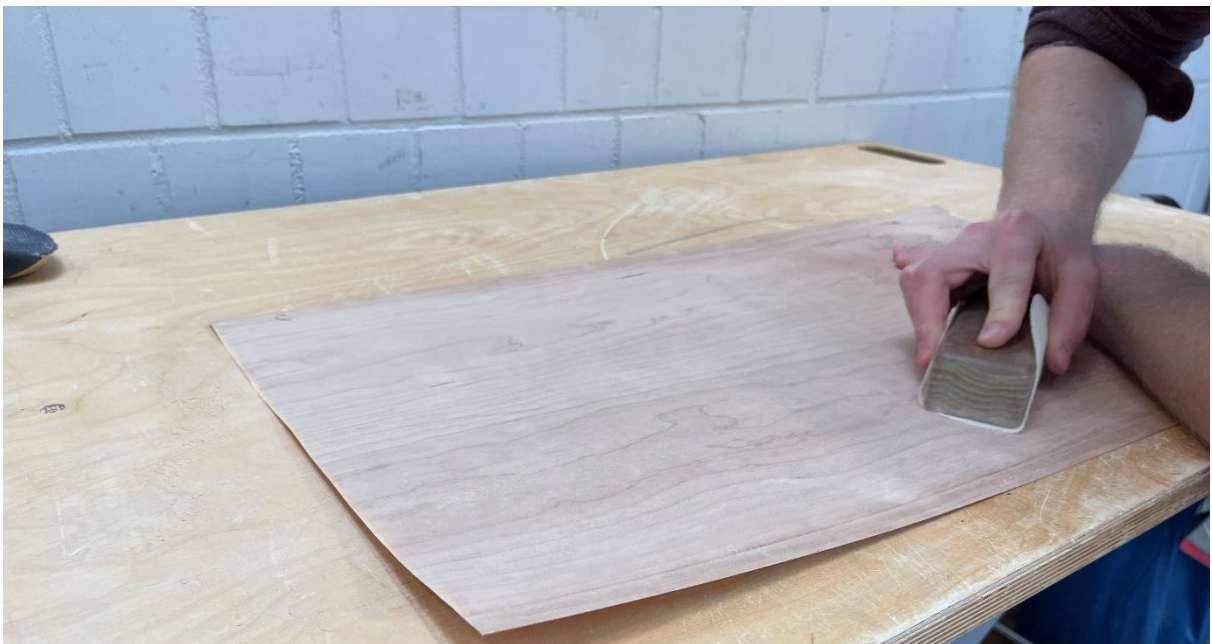
Abbildung 14: Furnier schleifen Quelle: Eigene Darstellung
