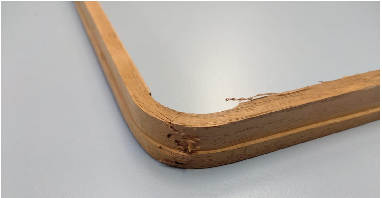
Abbildung 29: Ausrisse im Bogen des Griffes Quelle: Eigene Darstellung
