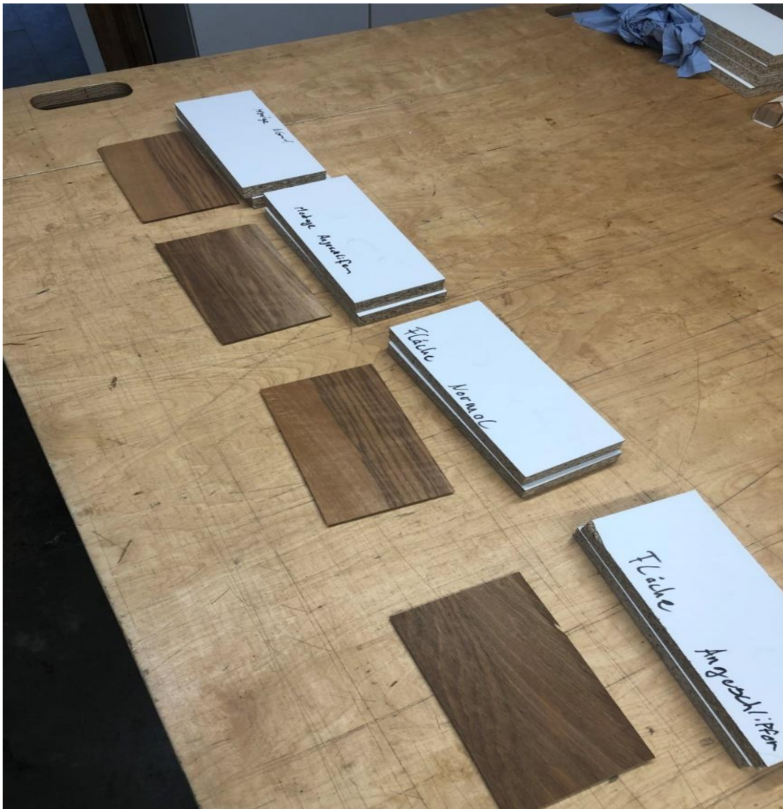
Abbildung 8: Verleimtes Furnier mit Acrylglas Quelle: Eigene Darstellung
