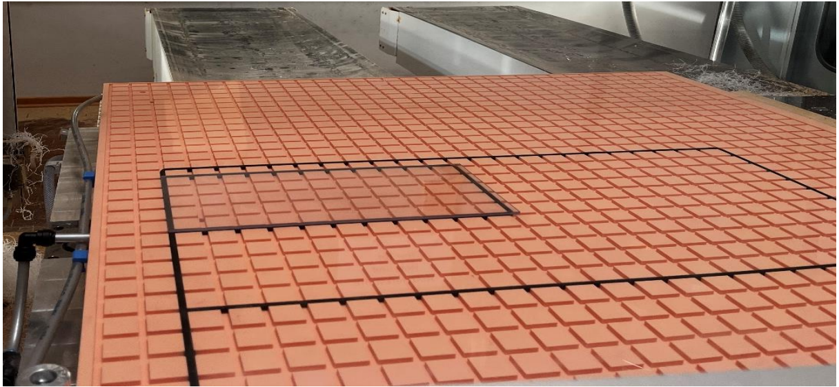
Abbildung 19: Acrylglas auf Vakuumvorrichtung Quelle: Eigene Darstellung
