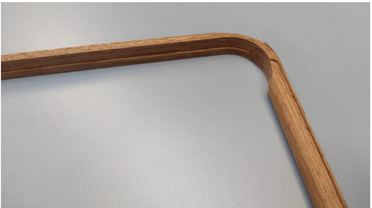
Abbildung 30: Toleranzverschiebung durch Fräser Versatz Quelle: Eigene Darstellung
