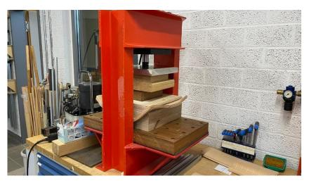
Abbildung 22: Pressen der Formteile (Eigene Darstellung)
