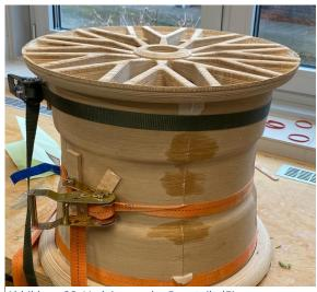
Abbildung 28: Verleimung der Formteile (Eigene Darstellung)
