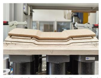
Abbildung 18: Luft unter der linken Rundung (Eigene Darstellung)
