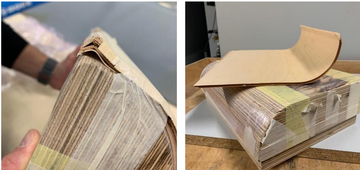
Abbildung: Eigene Aufnahme, gestauchte Furnierschichten (links), erster Pressversuch Schubkastenboden (rechts)
