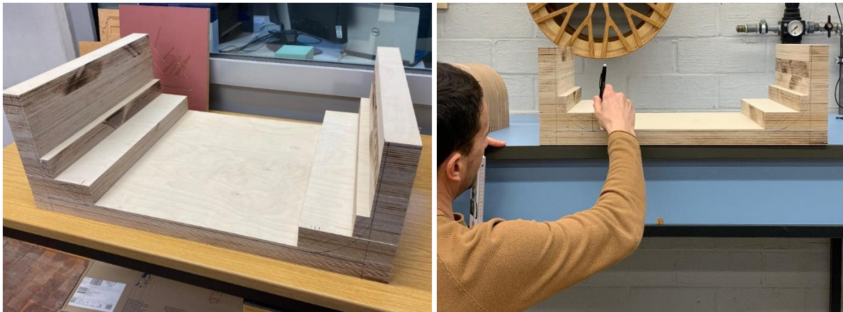
Abbildungen: Eigene Aufnahmen, Rohteil der Formatierungsform Korpushälfte (links), Abmessen der Spindelwege (rechts)
