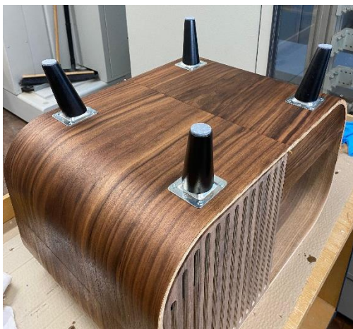
Abbildung: Eigene Aufnahme, Korpus von unten geölt, montierte Füße
