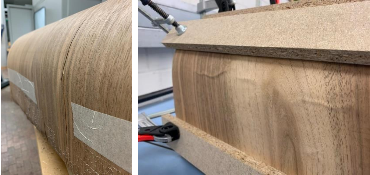
Abbildungen: Eigene Aufnahmen, Rissbildung nach erstem Pressversuch (links), Faltenbildung nach erstem Pressversuch (rechts)
