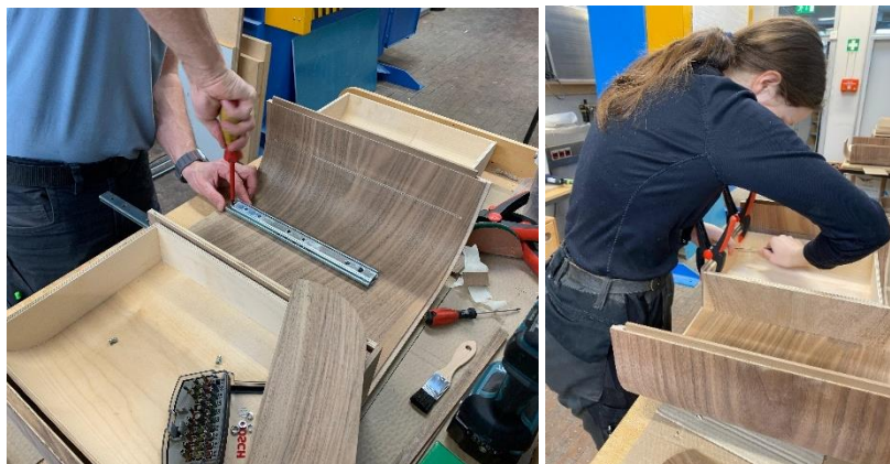
Abbildungen: Eigene Aufnahmen, Montage der Auszüge (links), Montage der Blende (rechts)
