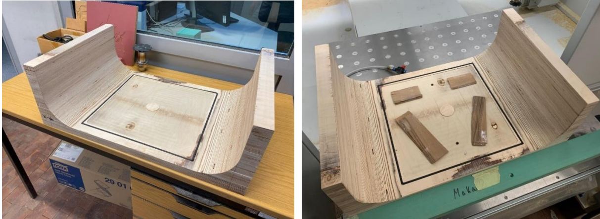
Abbildungen: Eigene Aufnahme, Formatierungsform mit Vakuumfeld
