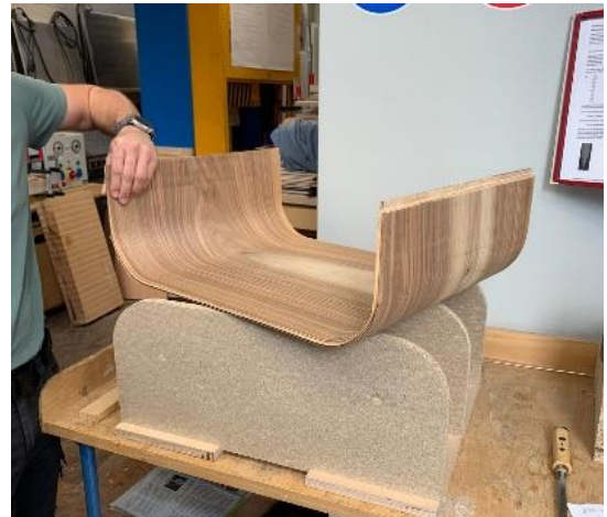
Abbildungen: Eigene Aufnahmen, Ergebnis Pressversuch der Korpushälfte noch eingepackt (links) und ausgepackt (rechts)
