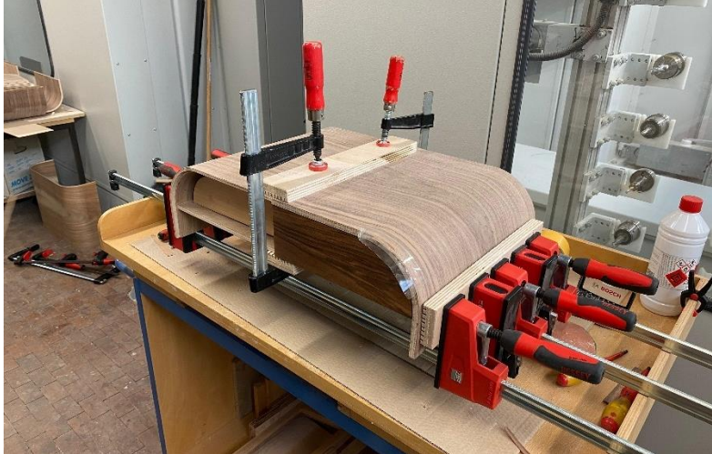
Abbildung: Eigene Aufnahme, Verleimprozess der unteren Korpushälfte und Konstruktionsboden
