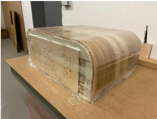
Abbildungen: Eigene Aufnahmen, Ergebnis Pressversuch der Korpushälfte noch eingepackt (links) und ausgepackt (rechts)
