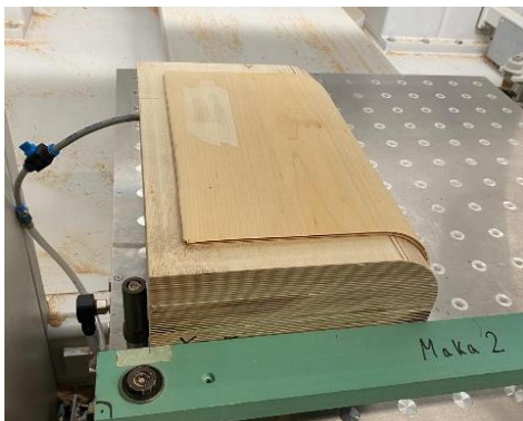
Abbildungen: Eigene Aufnahme, Schubkastenboden gespannt und bereit zum Formatieren (links), Screenshot aus AlphaCAM, NC-Pfad für Schubkastenbearbeitung (rechts)
