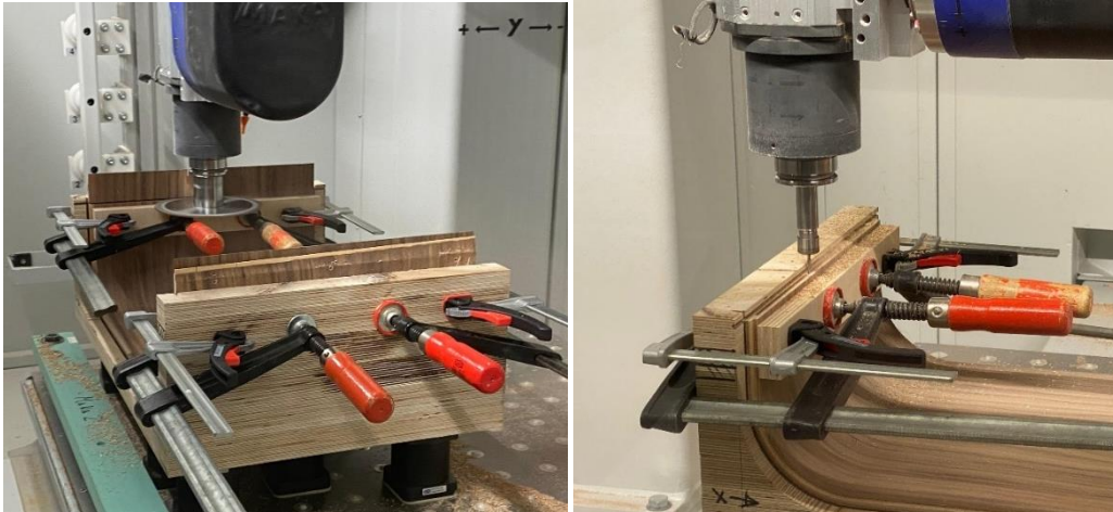
Abbildungen: Eigene Aufnahmen, Formatierschnitt (links), Fräsung der Stirnnut (rechts)
