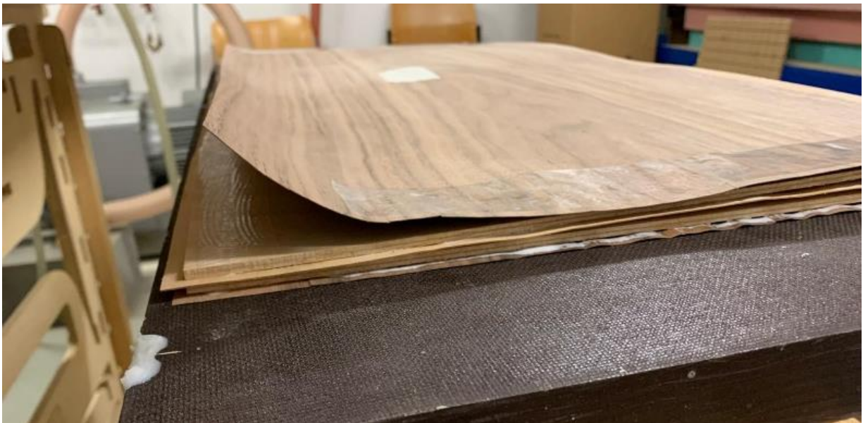
Abbildung: Eigene Aufnahme, Schichtaufbau der frisch geleimten Furniere
