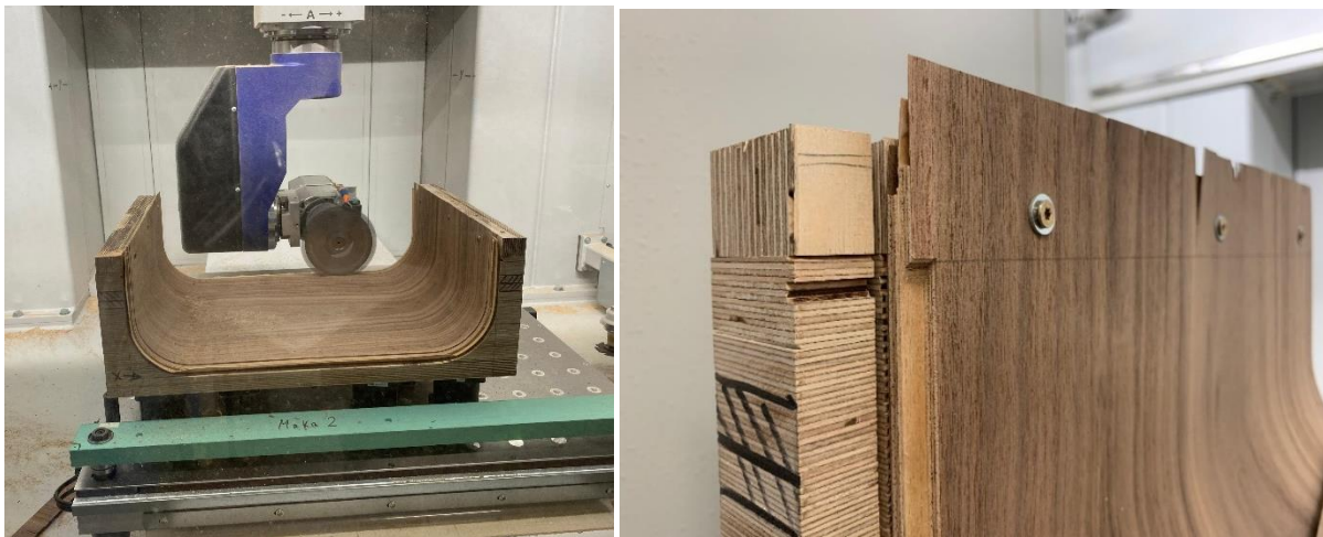
Abbildungen: Eigene Aufnahmen, seitlicher Formatierungsschnitt (links), mit Schrauben fixierter Überstand (rechts)
