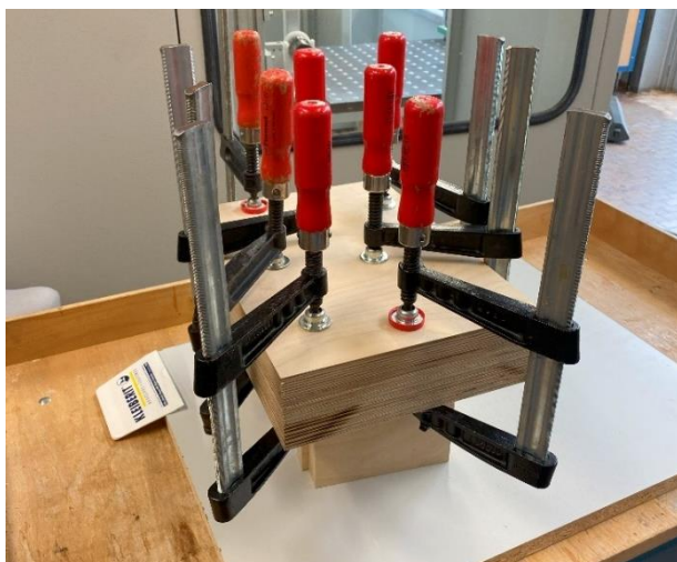
Abbildungen: Eigene Aufnahmen, Herstellung Schubkastenpressform
