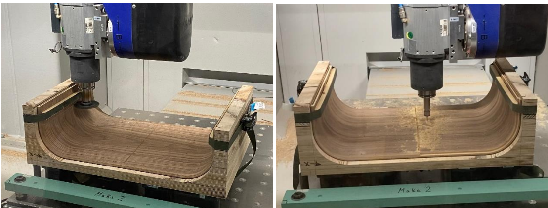
Abbildung: Eigene Aufnahme, links: Fräsung mit Lamellofräser, rechts: Mittelnut und Bohrungen
