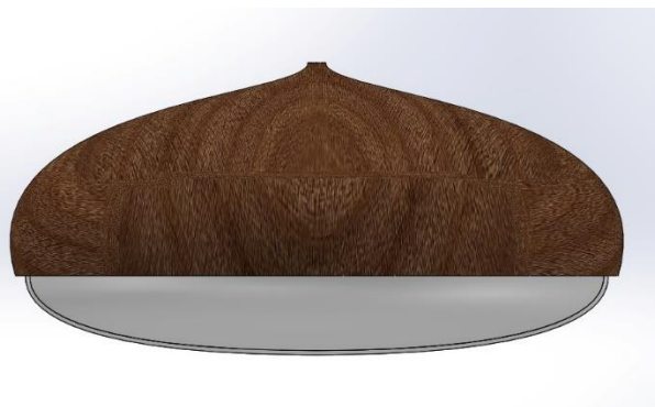
Abbildung 16: CAD-Modell mit Tiefziehteil als Blende
