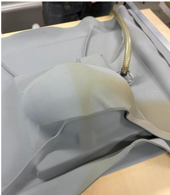
Abbildung 2: Pressversuch im Vakuumsack
