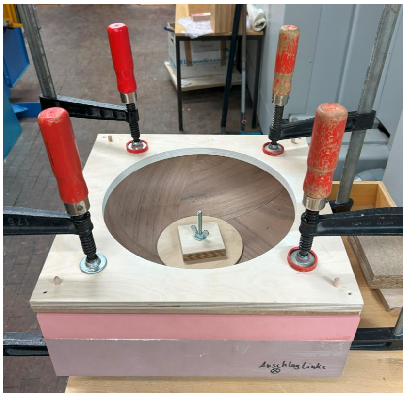
Abbildung 20: Verleimen der einzelnen Formholzteile in der Montageform
