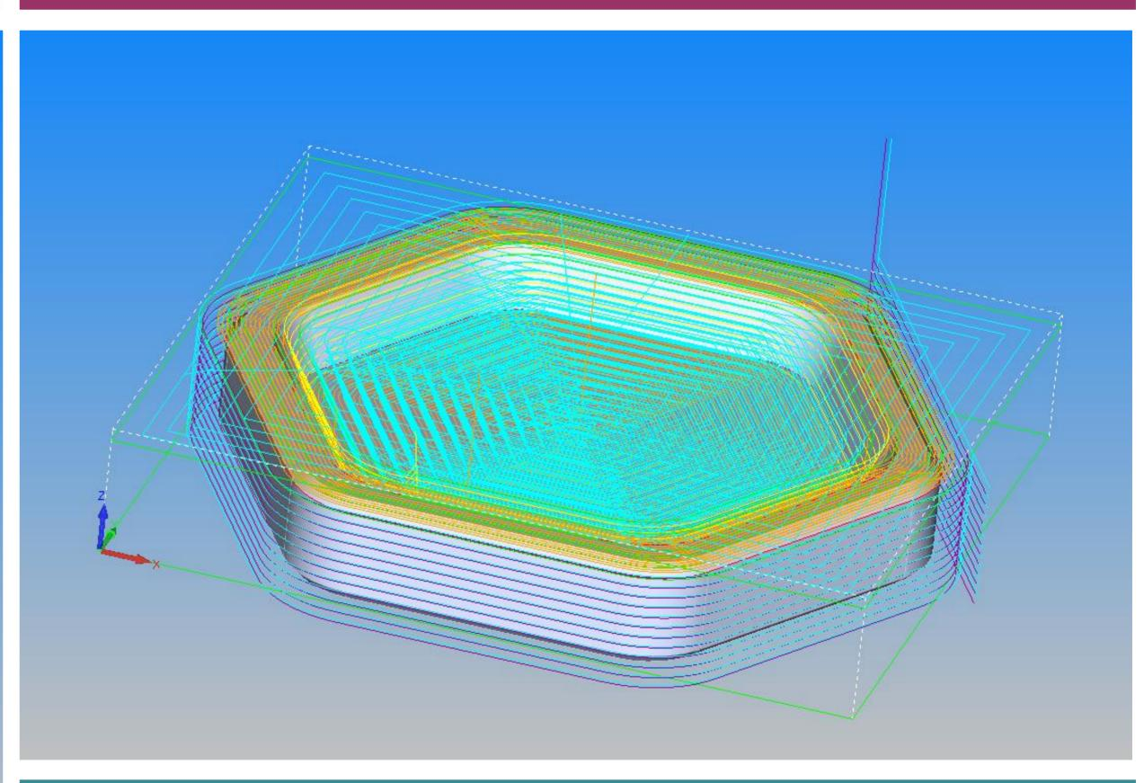
Bild links: Programmierung des Formteils Bild rechts: Programmierung des Würfeldeckels
