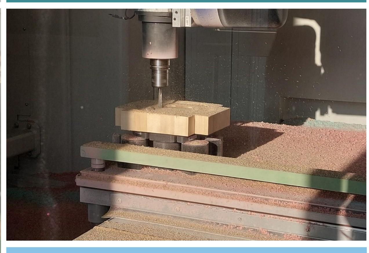
Bild links: Formatierung des Formteils Bild rechts: Fräsen des Würfeldeckels
